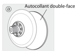
Nettoyer la surface et fixer le double-face. Placer l'embase de la molette sur ce dernier.
