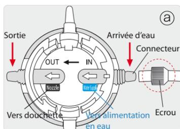
Insérer l'écrou sur le tuyau.
